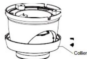
Retirez le collier de l'appareil photo en le faisant tourner vers le bas.
