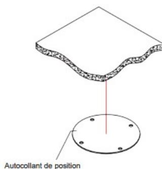
Appliquez l'autocollant de position sur la position de montage de la caméra souhaitée.
