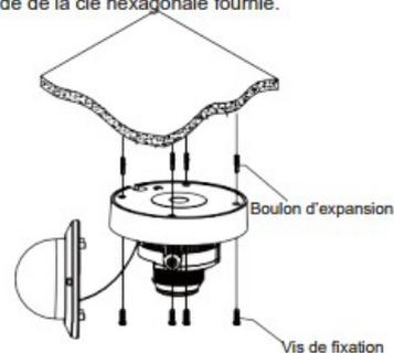
Utilisez la position indiquée sur l'autocollant de position pour percer les trous nécessaires au montage de la base de la caméra. Insérez le boulon d'expansion dans les trous. Faites correspondre les ouvertures de montage de la base à la position des boulons d'expansion, puis placez les vis de montage à travers l'ouverture de montage de la base dans le boulon d'expansion. Serrez les vis de montage pour vous assurer que la base de la caméra est correctement montée.
