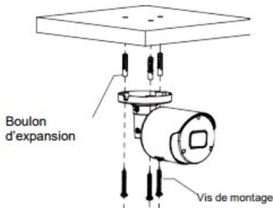
Insérez trois boulons d'expansion en place dans le plafond et fixez l'équipement avec trois vis de montage.
